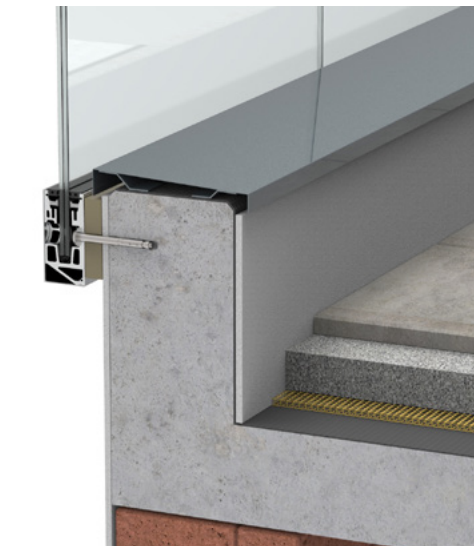
(D) Außenanwendung: Beispiel Balkon-Attika, Profil außen exterior application: example Balkon-Attika, Profil außen
